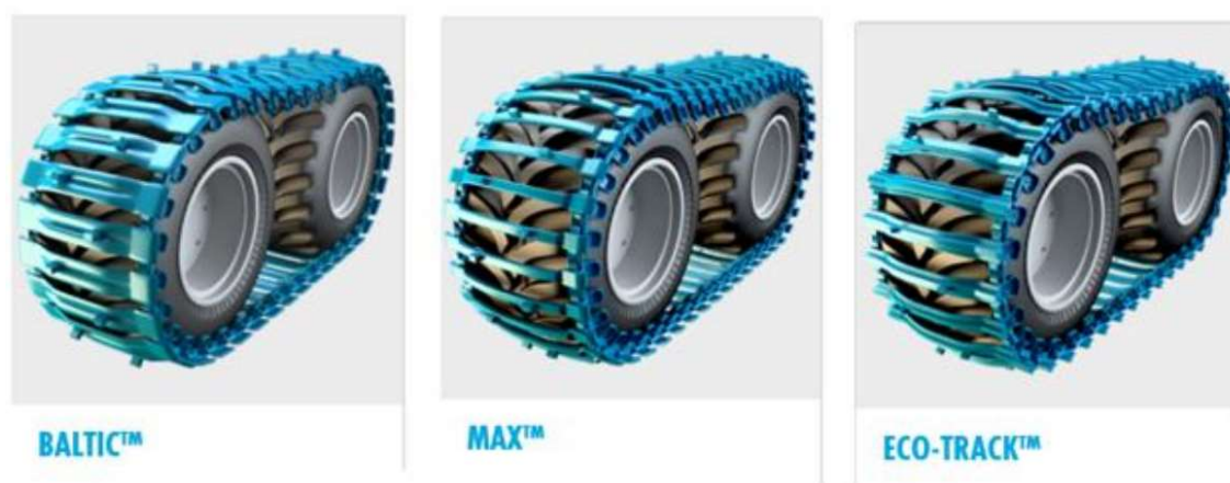
Figur 3. Illustrasjoner av ulike beltetyper, med forskjellig bredde på belteribbene. Baltic er typisk flytebelter for bæresvak mark, mens Max er aggressive belter for å ta seg frem i bratt og steinete terreng. Kilde: https://www.eco-tracks.com/products/eco-tracks
