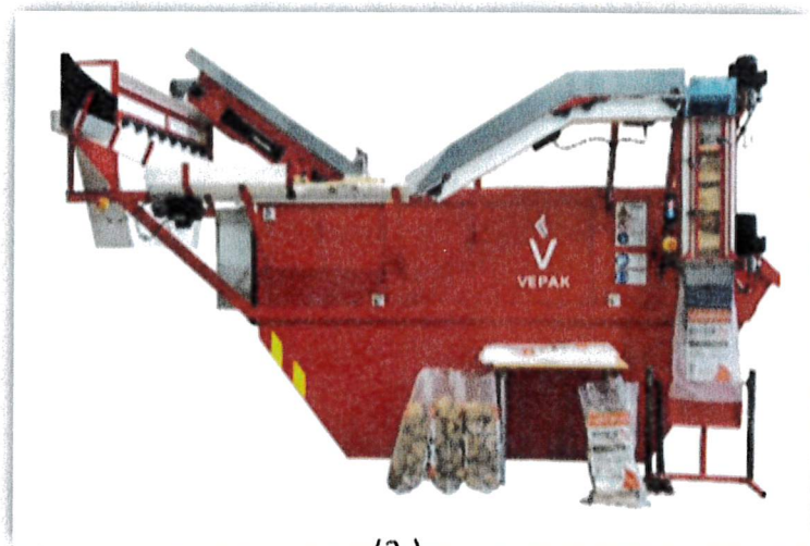
Bilde 3 – Vepak AS har utviklet en patentert løsning for effektiv pakking av fyringsved i småsekker, prosjektet er realisert med blant annet støtte fra verdiskapingsfondet.
